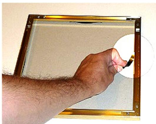
Insérez les ressorts entre le fond de cadre et le montant en aluminium, pour plaquer le tout
